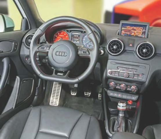
Drinnen belassen es beide beim Serienmobiliar mit rotem Drehzahlmesser, Ausklappnavi und einem gefrästen Aluköpfchen, mit dem man die sechs Gänge plüückt
